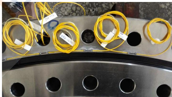
图 3.1 裂缝传感器安装示意图
