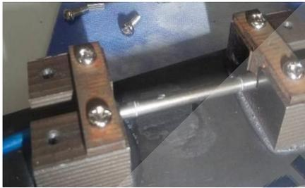
图 3.2 平面固定方式（粘接）
