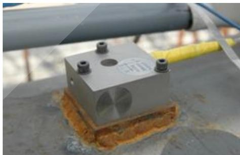
图4-12 三维加速度传感器安装
